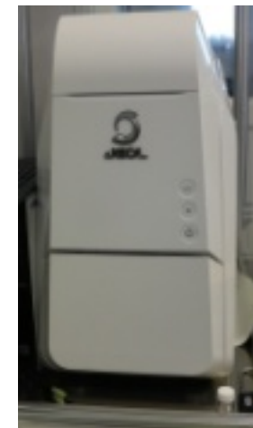
↑卓上走査型電子顕微鏡本体。下側を開き観察物の出し入れを行う。
