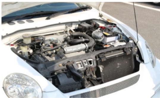
↑社外品ブローオフバルブが目目を惹く80馬力のJBD-DET型エンジン。よく目を凝らすと交換されたサスペンションの上部が見える。「狭いから整備しにくい」と崇人先輩は言う。
