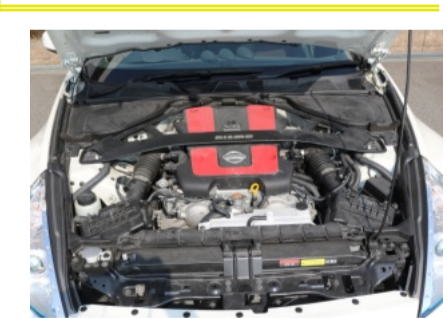
↑存在感たっぷりのVQ37VHR型エンジン。ニッパのタワーバーでボディ剛性の補強が施されている。
