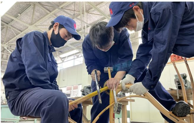
→自転車のフレームを弓鋸で切断する
